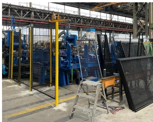
Figura 23. A sinistra la linea Schumag 2B riammodernata, a destra la nuova bisellatrice
