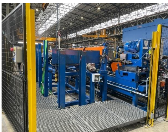
Figura 23. A sinistra la linea Schumag 2B riammodernata, a destra la nuova bisellatrice
