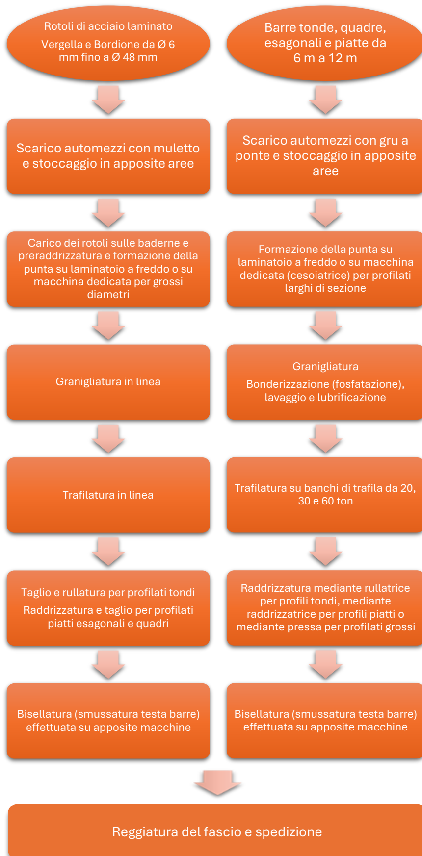
Figura 6. Rappresentazione grafica del processo produttivo
