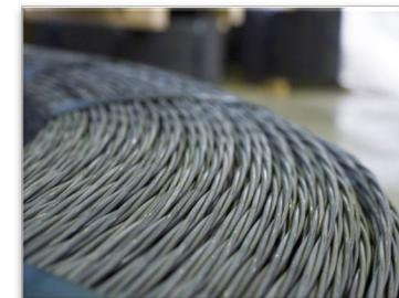
Trecce d'acciaio a 2 o a 3 fili per la realizzazione di opere leggere quali travetti, solai o pali per frutteti.
